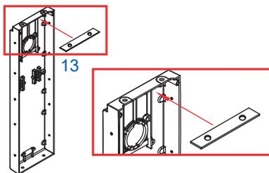
Gewindeplatten (13) in die Nuten der Seitenteile (3) einschieben
