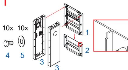
obere Rückwand (1) mit der unteren Rückwand (2) zusammenfügen und mittels 10 Stk Sechskantschrauben M8x16 (4) und Scheiben (5) mit den Seitenteilen (3) verschrauben
