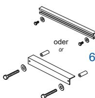
Zugentlastung (6) mittels 2 Stk Schrauben M8x16 und Beilagen M8 bzw. mittels 2 Stk Schrauben M8x75 und Beilagen M8 an der oberen Rückwand (1) fixieren
