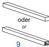
Stabilisierungsschiene (9) in die vorgesehenen Aufnahmen in den Seitenteilen (3) einrasten
