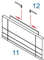
Steckteil (11) auf die mittlere Frontplatte (8) aufsetzen und mit 2 Stk Scharnierkunststoffbolzen (12) befestigen
