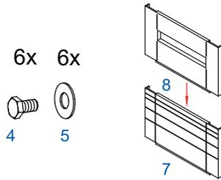
mittlere Frontplatte (8) auf untere Frontplatte (7) aufsetzen und mittels 6 Stk Sechskantschrauben M8x16 (4) und Scheiben (5) mit den Seitenteilen (3) verschrauben
