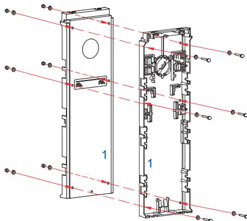
Gebohrte Seitenteile (1) mittels Sechskantschrauben M8x20 (2), Beilagen (3) und Muttern M8 (4) miteinander verschrauben.
